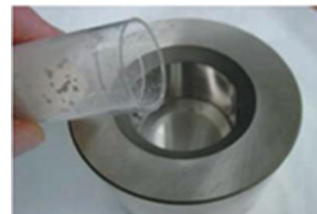
Pour the mix into the die
